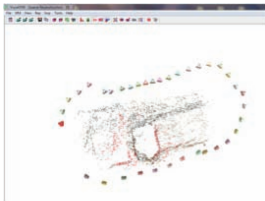
Fig.110. Détail de la position des caméras dans l'espace pour la production d'un nuage de points. Sont visibles sur la photo les points d'intérêt.
