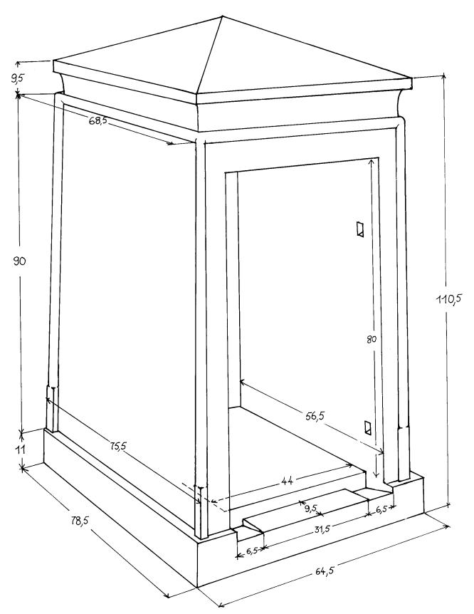
Fig. 1. — Caractéristiques architecturales et dimensions.
