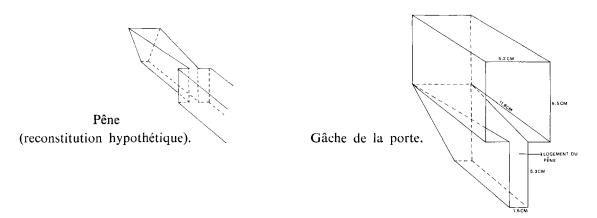
l'élément immobile de la charnière; dans le montant opposé, le pêne s'enfonçait aisément dans la cavité supérieure de la gâche pour s'abaisser dans la partie inférieure adaptée à son contour.
