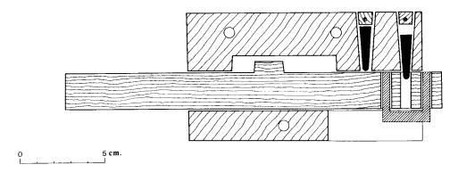
Fig. 15. — Tentative d'ouverture avec une clé à 2 dents.
