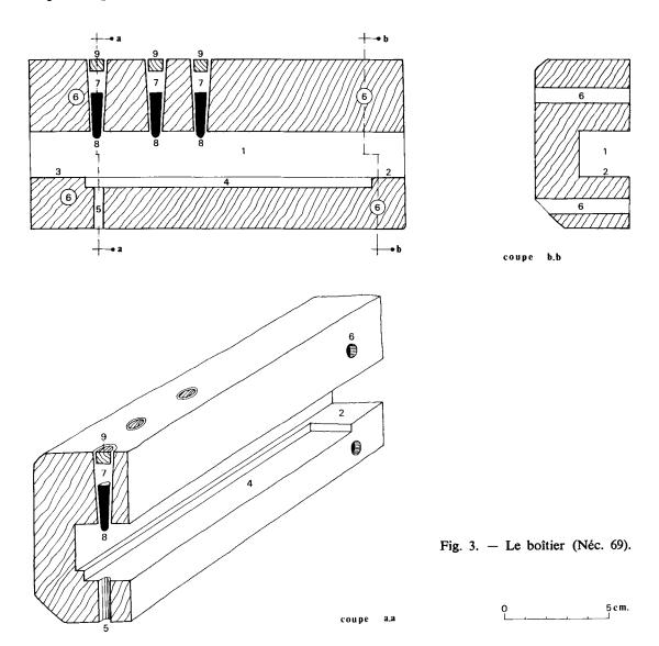
est percé un trou vertical (5) dont nous verrons plus loin la fonction. Quatre trous de fixation (6) de 6 mm de diamètre et de 4,5 cm de profondeur sont percés dans les quatre coins de la pièce, pour les quatre clous qui maintenaient le boîtier derrière la porte.
