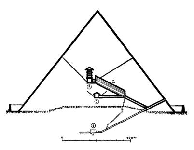
Fig. 14. — Coupe de la pyramide de Khéops montrant les 3 plans successifs de ses chambres et galeries.
