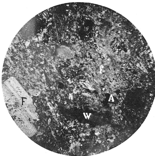
I. — Section mince dans le porphyre antique vue au microscope, faible grossissement. F , feldspath oligoclase-andésine; f , même feldspath mais microlitique; A , amphibole hornblende; W , withamite.
