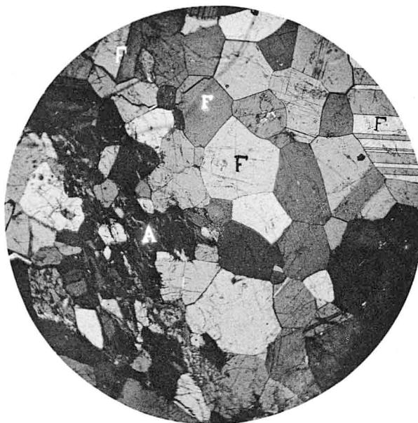
II. — Anorthosite vue au microscope à la lumière polarisée. A , amphibole ; F , feldspath bytownite.
