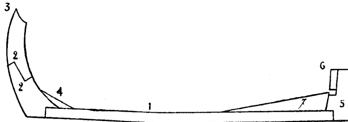
Fig. 1. — Schéma de la quille avec l'étrave et l'étambot.
