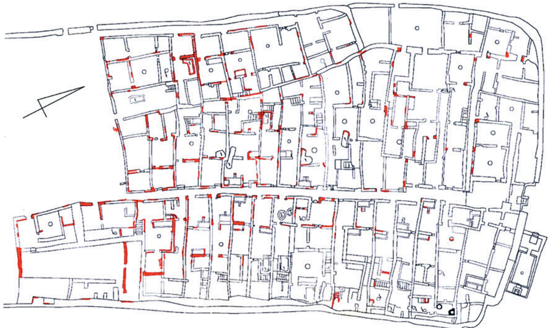
FIG. 1. Détail du plan de B. Bruyère avec additions de C. Gobeil. En rouge, les structures déjà tombées ou qui étaient dans un état de dégradation avancée (état mars 2012).
