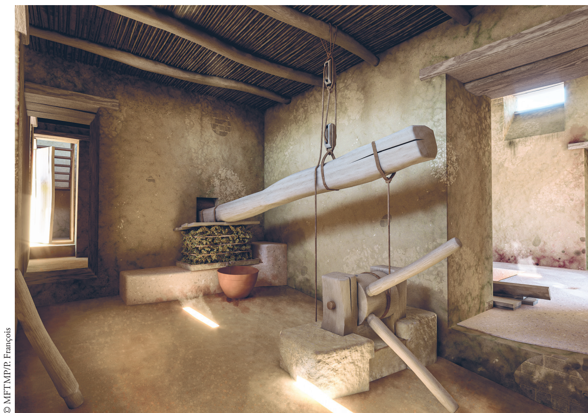
FIG. 12. Reconstitution du pressoir à levier et treuil du chai ptolémaïque de Plinthine.
