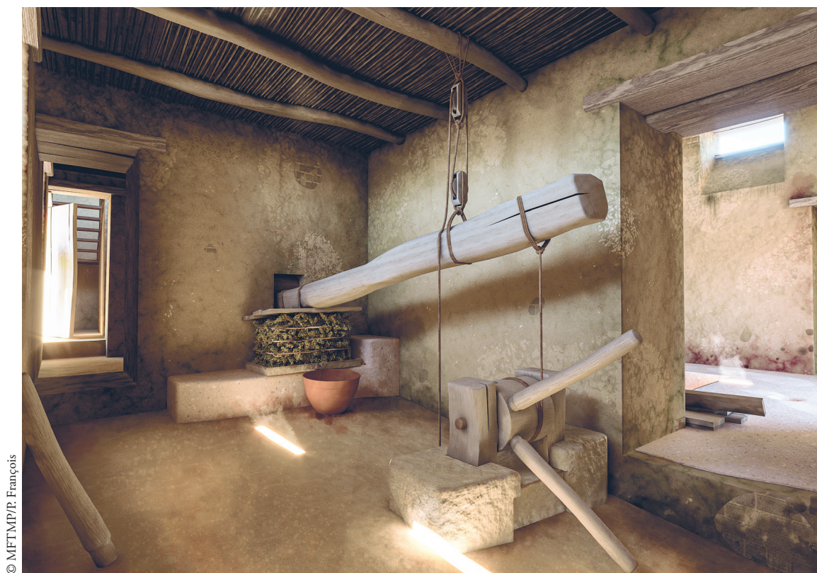
FIG. 12. Reconstitution du pressoir à levier et treuil du chai ptolémaïque de Plinthe.
