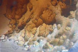
Fig. 5. Coupe transversale des fibres de lin (à gauche) et de chanvre (à droite) à 500X. Photos: R. Romero.
