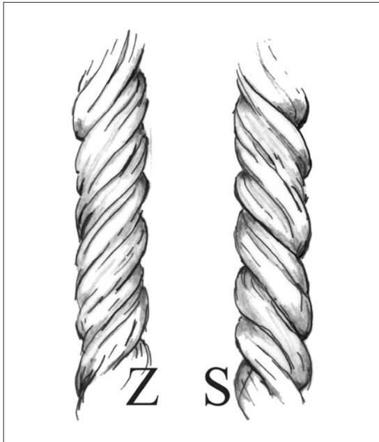
FIG. 2. Torsion des fibres. Dessin : Proyecto Djehuty/P. Rodríguez Frade.
