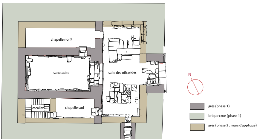
FIG. 4. Phase 2: murs d'applique mis en place par Ptolémée II Philadelphie (fin de la première moitié du III e s. av. J.-C.) [d'après F. Daumas].
