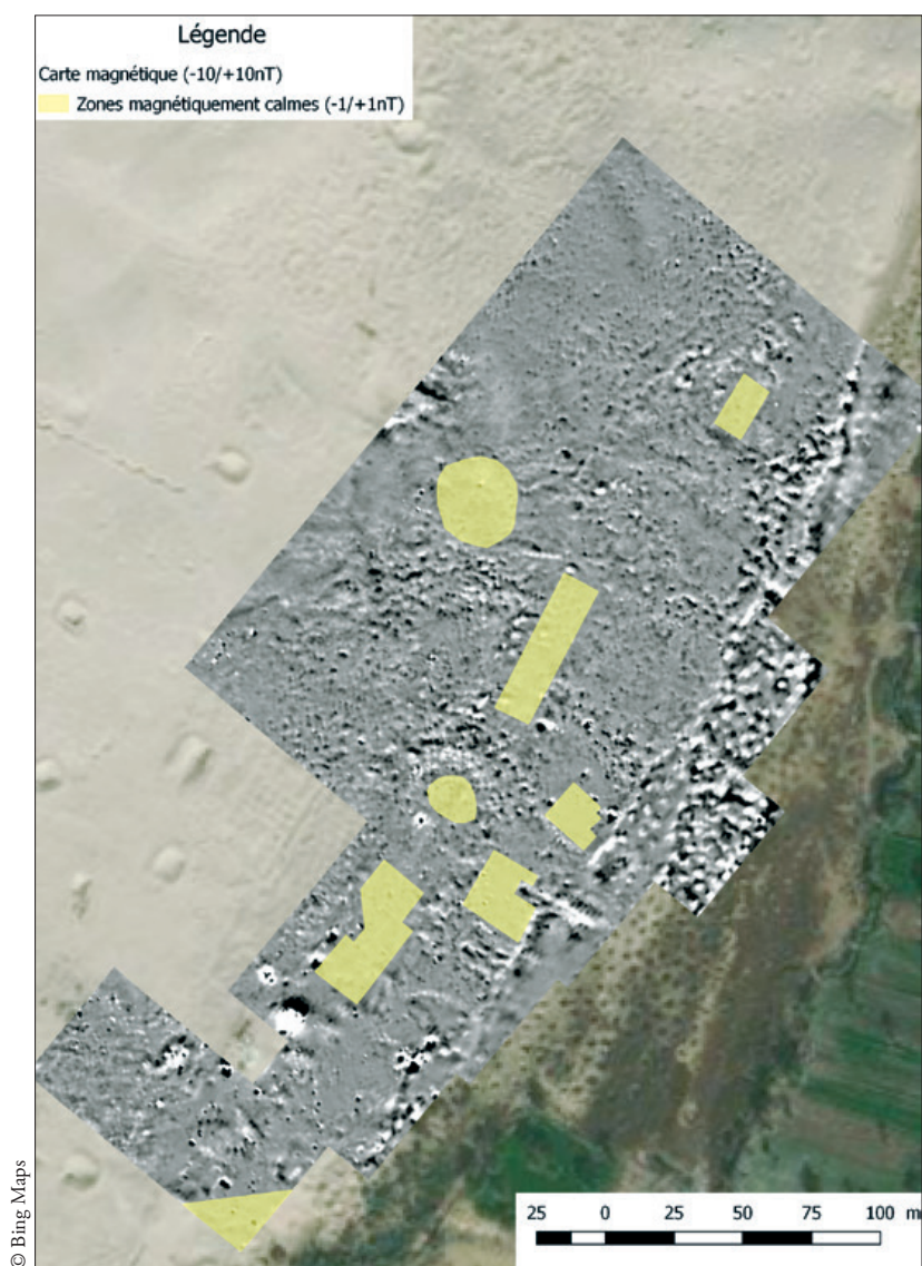
FIG. 14. Carte magnétique générale avec zones magnétiquement homogènes ( -1/+1nT ).
