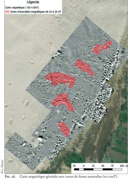
FIG. 16. Carte magnétique générale avec zones de fortes anomalies (10-20nT) sur fond d'image Microsoft Bing.
