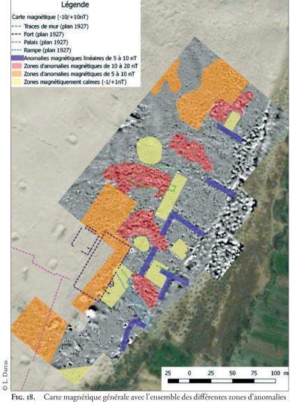
Fig. 18. Carte magnétique générale avec l'ensemble des différentes zones d'anomalies sur fond d'image Microsoft Bing.
