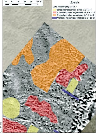
Fig. 21. Carte magnétique (-5/+5nT) dans la partie nord de la zone prospectée sur fond d'image Microsoft Bing.
