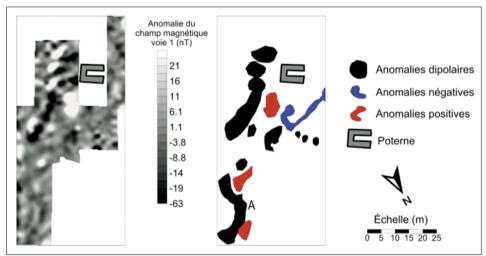
Fig. 9. Carte d'anomalie magnétique du capteur du bas (gauche) et interprétation (droite) sur la zone Pio/OII.
