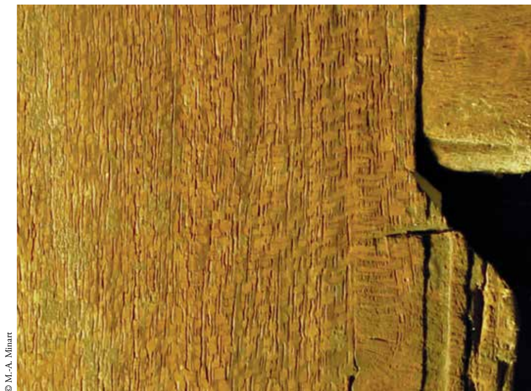
FIG. 21. Bois «maillé»; trait de coupe malencontreux ou correspondant à une réparation.
