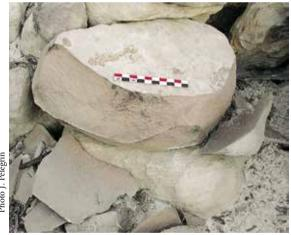
Fig. 2. Pierrier de blocs de calcaire affectés d'un décollement d'écailles thermiques au cours d'un incendie.
