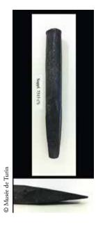
Fig. 40. Ciseau de bronze (longueur 18 cm, diamètre 2,2 cm) S 7515 du musée de Turin. Son biseau nettement plus aigu que celui de la fig. 39 pouvait le rendre apte au fendage du calcaire lité.
