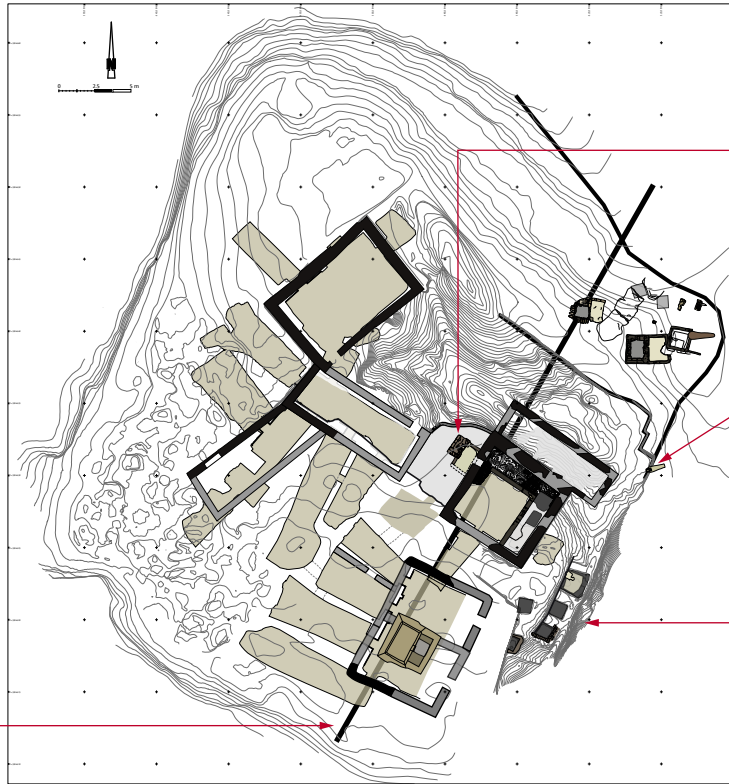
Plan masse du site de Tabbet el-Guech (2013) : les courbes de niveau ont été générées directement à partir du MNT issu du modèle 3D obtenu par photogrammétrie.
