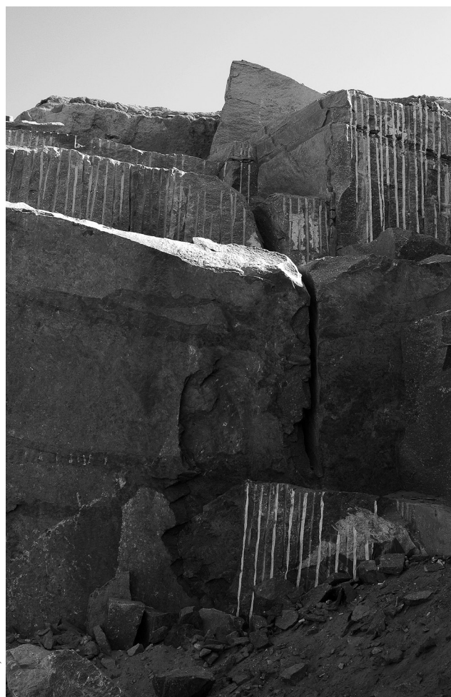
FIG. 12. Front de masse tranché récemment à l'aide du « jeu de flamme », dans la carrière du Gebel al-Mesalla (profondeur de la tranchée: 3 m; largeur: 20 à 25 cm environ).
