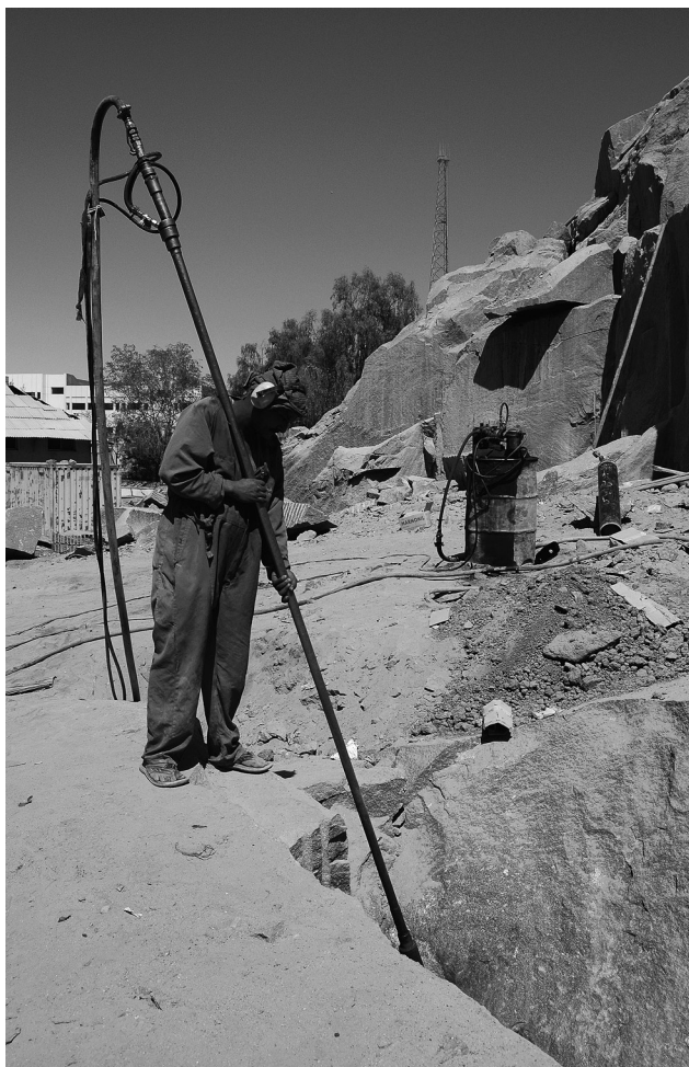
FIG. 11. Tranchage du granit avec le « jeu de flamme » dans une carrière en activité d'Assouan (Gebel al-Mesalla).
