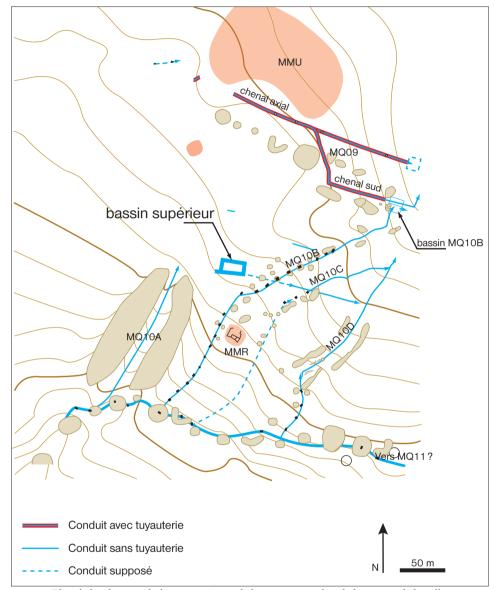
FIG. 3. Plan de localisation du bassin supérieur de la *qanât* MQIO dans le bassin est de la colline.
