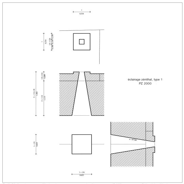
Fig. 7. Détail en plan, coupe et élévations du type 1, commun aux chapelles rayonnantes (D à M) et aux espaces P, U et V. Les élévations sont BIFAGDattyes्zថ្លាស្លាំ|e-prodommente idea អូចិចនិង ឲ្យបានអាចមាន valeurs de coudée sont exprimées sous leur forme fractionnaire au-dessus de la Espaigles de ក្រុមនេះ ខែមហាវិទ្ធាន អូចមហាវិទ្ធាន អូ
