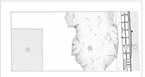
1. Fondation du mur péribole, maçonnerie type grand appareil de grès. 2. Muret en briques crues du caisson de fondation monté contre la fosse de fondation verticale. 3. Aire de préparation de mortier blanc. 4. Silo rempli de cendre et céramique. 5. Massif de briques.
