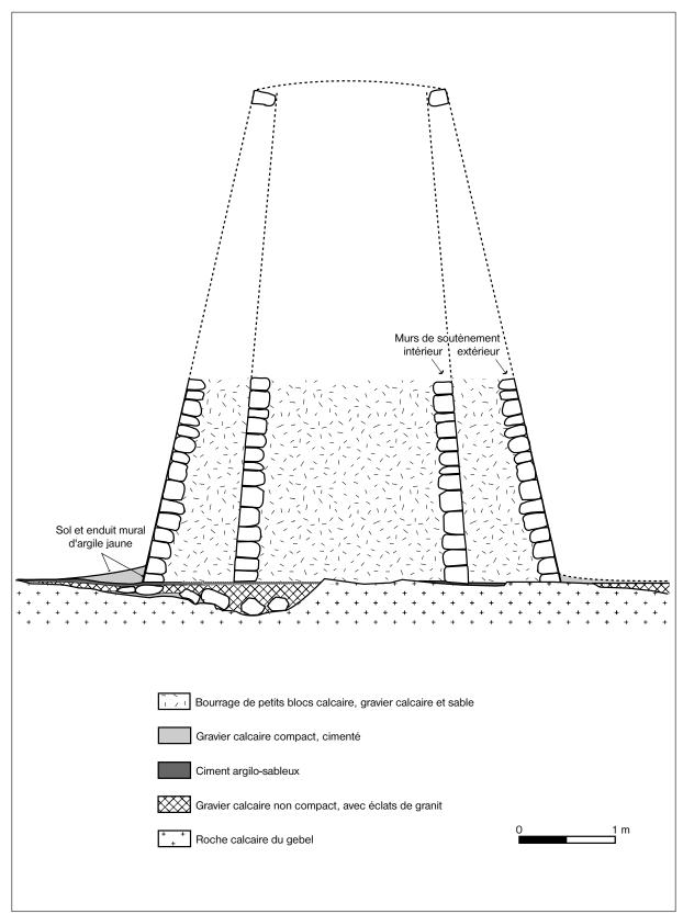
Fig. 3. Les fondations du mur d'enceinte intérieur, synthèse de deux situations selon l'affleurement du gebel.
