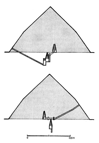
Fig. 10. — La pyramide rhomboïdale, coupes Nord-Sud et Est-Ouest.
