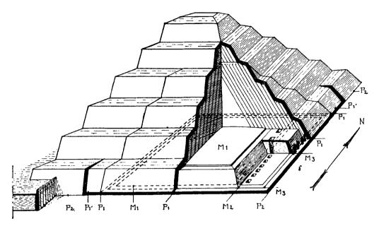
Fig. 4. — Schéma perspectif des états successifs de la Pyramide à degrés.
