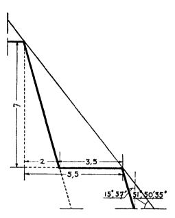
Fig. 9. — Détermination du profil du 3° état de la pyramide de Meïdoum.
