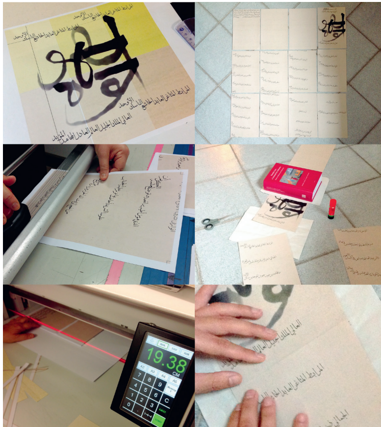
Fig. 4. Étapes de la fabrication (photos prises avec l'aimable autorisation du Balduzzi copy center, Bologna). À gauche : en haut, l'impression de différentes tonalités de texture pour choisir le rendu d'impression ; au milieu, le découpage manuel des feuilles ; en bas, le découpage des feuilles à la machine. À droite, en haut : les 12 feuilles avant collage ; au milieu, le matériel pour le collage ; en bas, le collage suivant les dimensions du kollésis.
