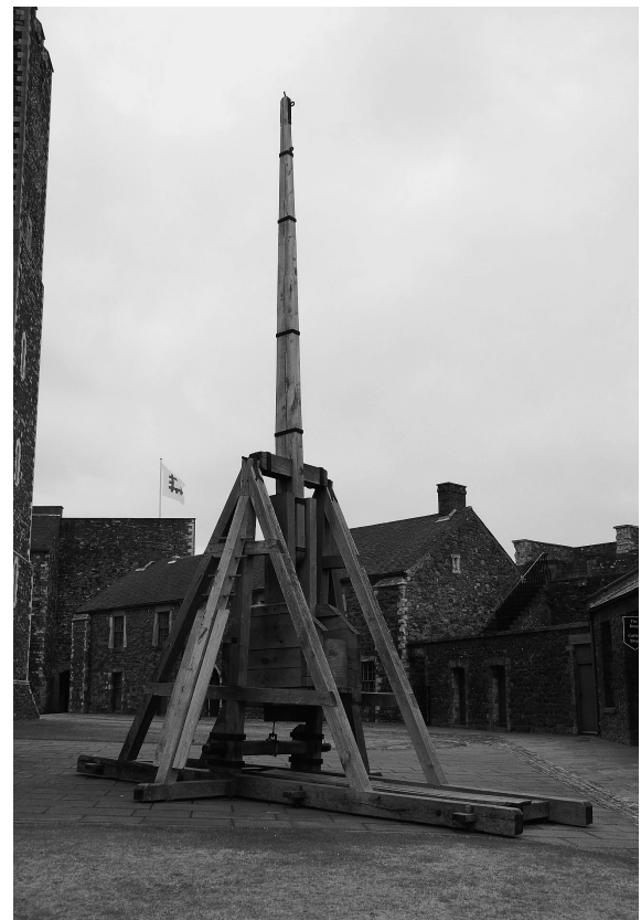
Fig. 9. Trébuchet à contrepoids (château de Douvres, Angleterre).
