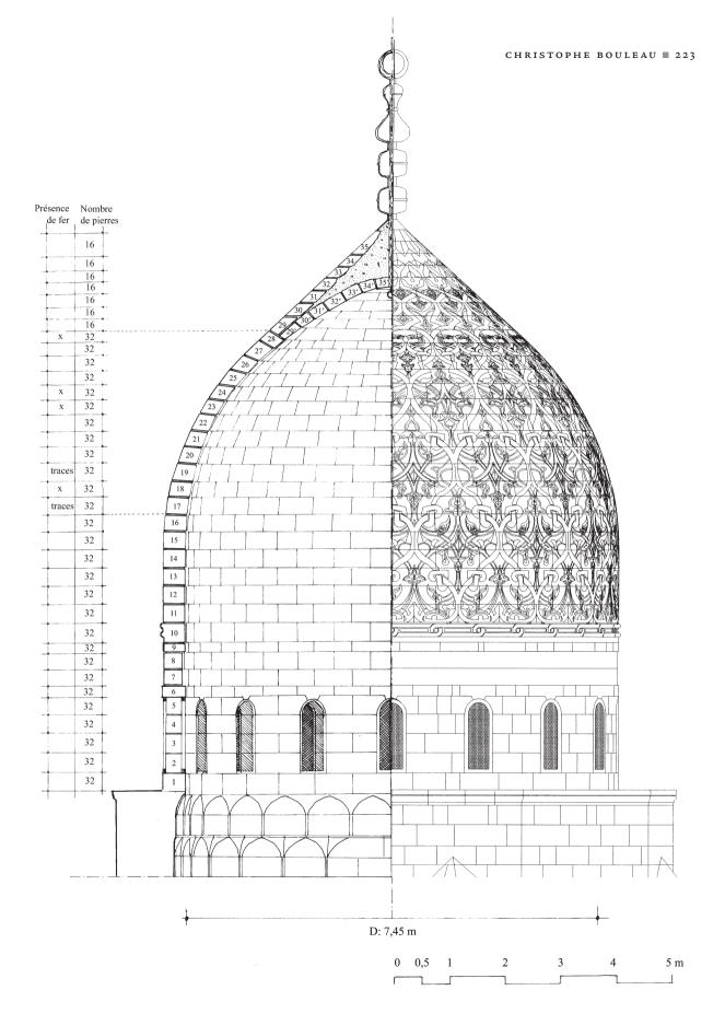
Fig. 12. Coupe-élévation de la coupole.
