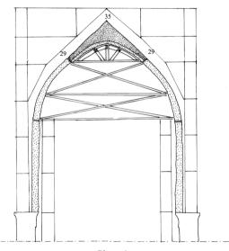
Phase 4 Construction des assises 29 à 35 Le cône sommital est bâti en tas de charge
