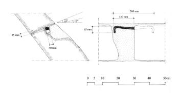
Fig. 19. Détail d'une agrafe en fer.
