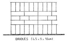
Fig. 5. — Détail de l'appareillage.
