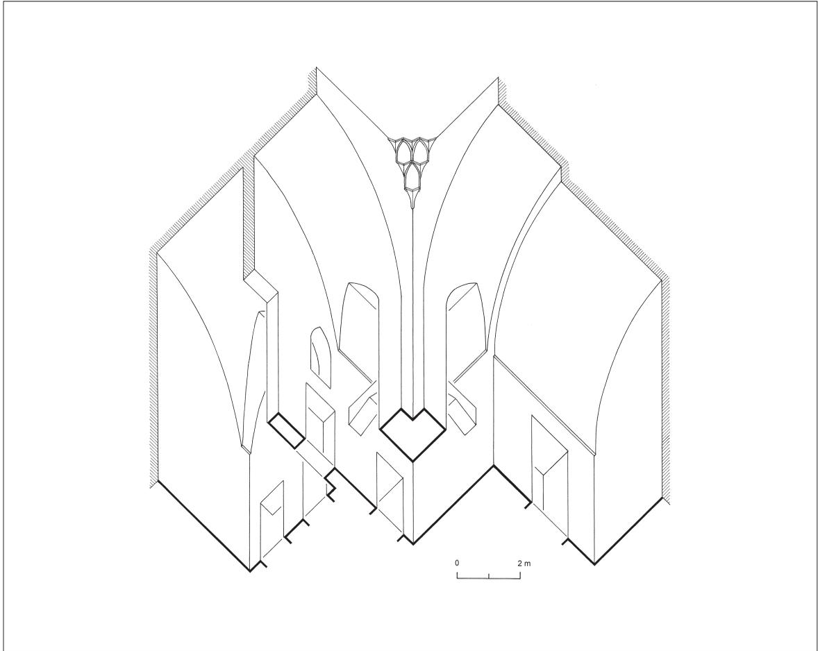
**Fig. 24.** Angle nord-ouest de l'espace central, axonométrie restituée.
