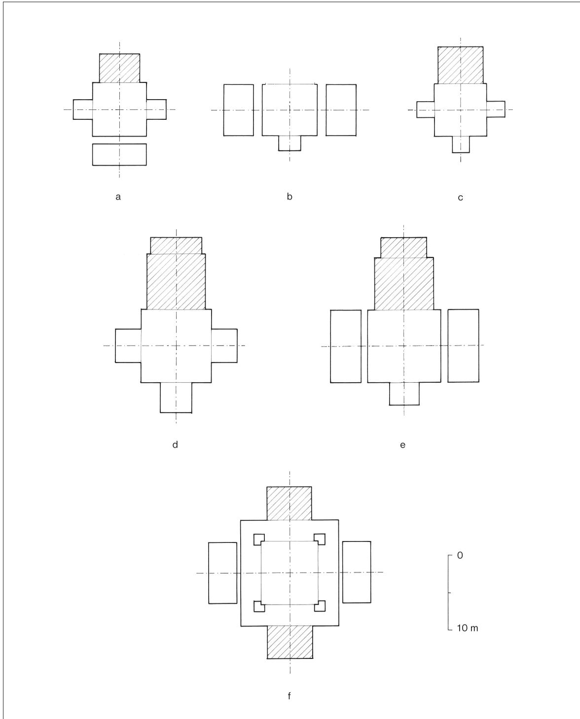
**Fig. 27.** *Qa'a-s* de Syrie du Nord, planche comparative de la position des iwans principaux : **a.** Qal'at Nağm ; **b.** Biredjik, citadelle ; **c.** Şahyün ; **d.** Alep, citadelle ; **e.** Alep, Maṭbaḥ al-Ağami ; **f.** Muazzara.
