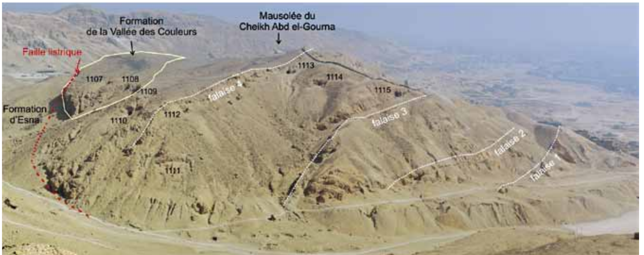
FIG. 10. Disposition des unités lithologiques sur le versant sud-ouest de la colline de Cheikh Abd el-Gourna, vers la Vallée des Couleurs. Position de quelques tombes MMA.
